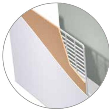
Piastra positiva: Griglia incorniciata con lega altamente tecnologica. Il separatore in lana di vetro ad elevata capillarità assicura il totale assorbimento del massimo volume di acido, per evitare la stratificazione.
